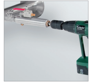
CS delme tertibatı ile basınç altında delme
