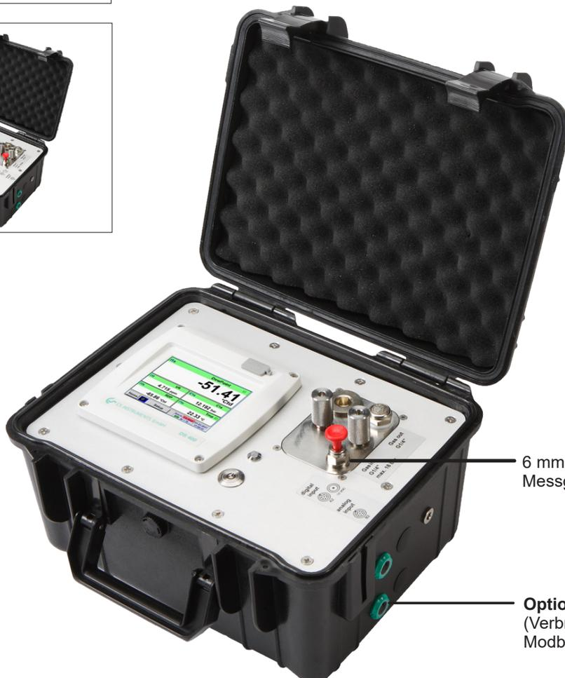
6 mm Steckanschluss zur Messgas-/ Druckluft Zuführung
